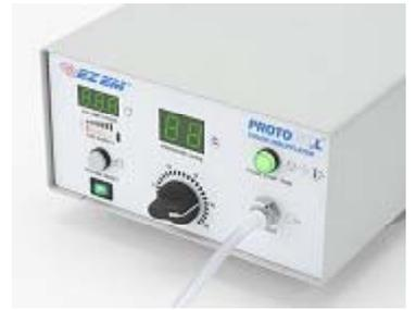
「プロトCO2L」は、医療用炭酸ガスの送気と送気量の管理を自動で行う装置であり、専用のディスポーザブルチューブである「プロトCO2L カテーテルセット」を用いて、肛門から炭酸ガスを注入して大腸を拡張します。
